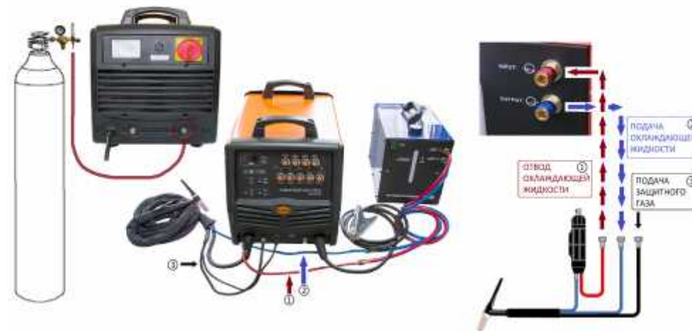
Схема подключения установки для аргодуговой сварки со стандартной горелкой
