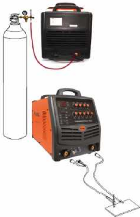
Схема подключения установки для аргонодуговой сварки со стандартной горелкой
