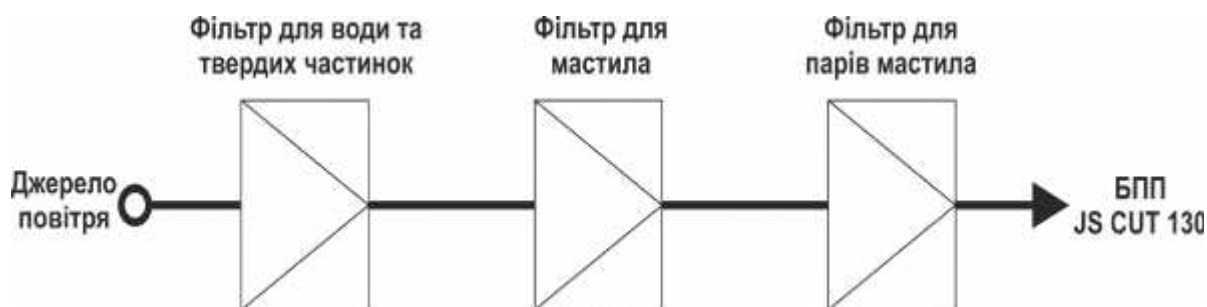
Рисунок 6-2. Система трьохрівневої фільтрації повітря
