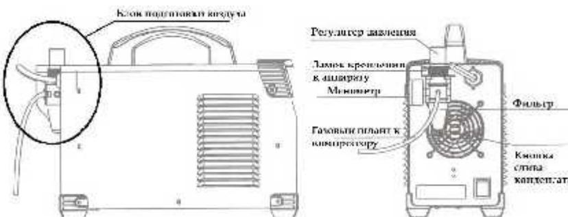
В данных моделях аппарата блок подготовки уже установлен на корпусе в специально предназначенней нише, защищённой от механических повреждений при транспортировке и эксплуатации.
