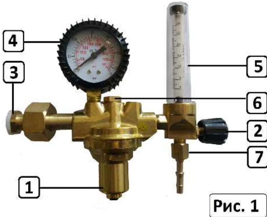
1 – корпус редуктора; 2 – винт задающий расход газа; 3 – входной штуцер с накидной гайкой G3/4"; 4 – манометр входной; 5 –расходомер (ротаметр); 6 - клапан предохранительный; 7– ниппель Ду 6 с накидной гайкой.
