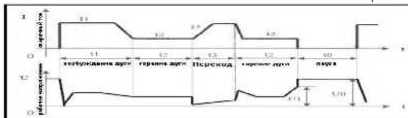
Внимание: t0 – пауза: отсутствует сварочный ток, напряжение холостого хода.
