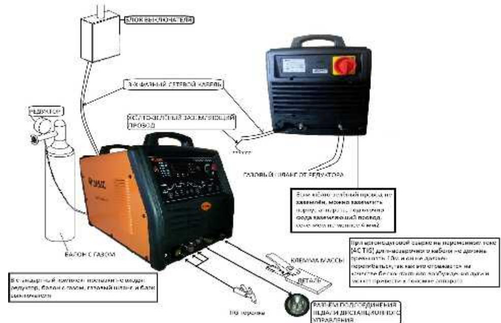
На рисунке выше изображено подсоединение тока обратной полярности для аргонодуговой сварки на постоянном токе (DC TIG) и импульсной сварки (pulsed TIG). При использовании тока прямой полярности, силовой кабель горелки и обратный кабель меняются местами. Сварка током прямой полярности используется только при работе со специфическими материалами. При аргонодуговой сварке на переменном токе, подсоединяйте кабеля, как указано на рисунке выше.
