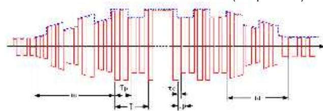
**tc** – время катодного тока; **tp** – период пульсации переменного тока; **T<sub>p</sub>** – время максимального тока импульса; **T** – период импульса
