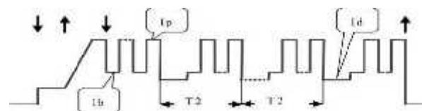
**I<sub>b</sub>** и **I<sub>p</sub>** – базовый ток и максимальный ток импульса (в режиме импульсной сварки); значение **I<sub>d</sub>** равно значению тока дежурной дуги, но этот ток не относится к дежурной дуге и может рассматриваться, как вторичный базовый ток. Время **T<sub>2</sub>** – продолжительность вторичного импульса и в нашем примере равно 200 миллисекундам. В режиме сварки 19 период вторичного импульса может быть изменён в любое время, путём изменения продолжительности спада тока.
