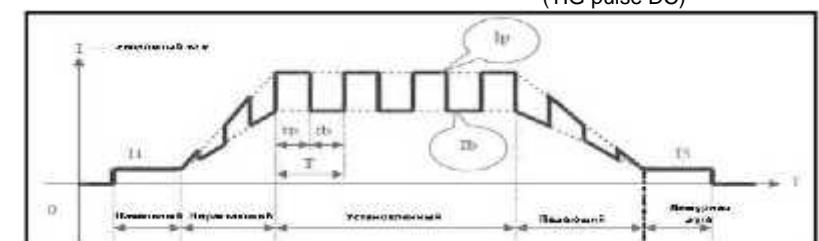
В режиме импульсной аргонодуговой сварки регулируются все те же параметры, что и при аргонодуговой сварке на постоянном токе, КРОМЕ значения тока I3, а также четыре дополнительных параметра, описанных ниже:
